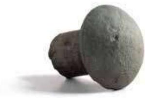
↑ Историческая заклёпка, по образцу которой были созданы новые высокопрочные болты с полукруглой головкой
